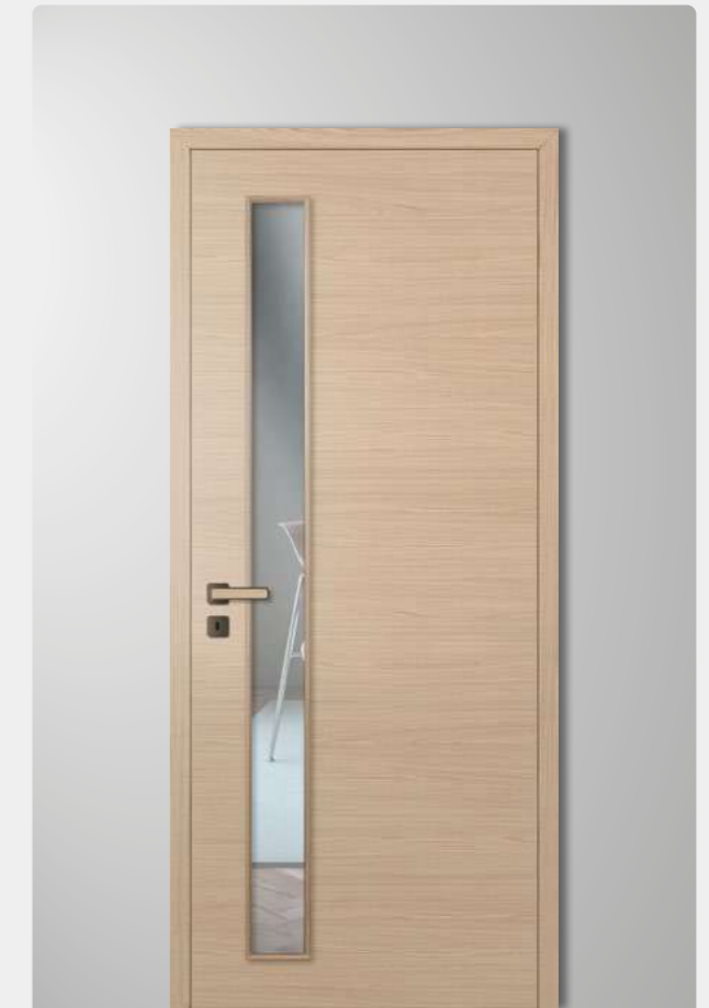
Modell Glatt | stumpf | Effekt Eiche Corda quer CPL | Lichtausschnitt LA 114 Verglasung „Float hell“ | Zarge smart 2 kante 60 mm | Drücker ›Quadro Plug In‹
