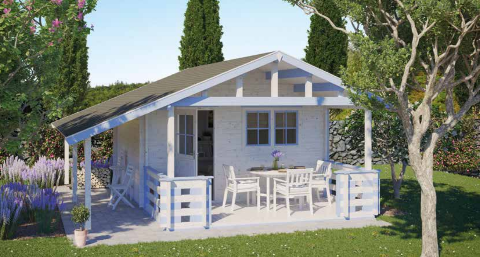
Terrasse aus imprägnierten Glattkantenbrettern ca. 23 x 95 mm auf imprägnierter Unterkonstruktion. Geländer umlaufend aus Bohlen, mit Handlauf (100 mm Breit) Brüstungshöhe ab Oberkantbelag (790 mm)
