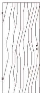
FN/K1 längsfurniert (Klima 1) Türstärke 40 mm
