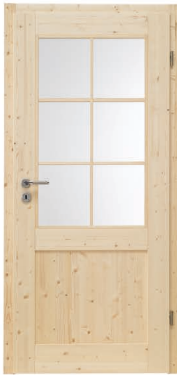
Landhaustür LS/2F-SP6, Fichte astig roh, OG-Zarge 65mm, Verglasung Klarglas
