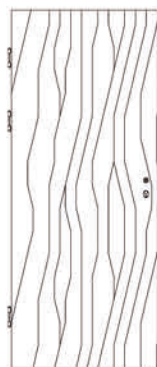
FN/K3 längsfurniert (Klima 3) Türstärke 43 mm, PZ, Schall-Ex
