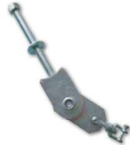
22 Schwinghaken verzinkt, mit Kugellager in einer 10 mm dicken Stahlplatte. Nylonlager (außen Ø 15 mm, innen Ø 6 mm) für die Befestigung von Ketten, Gesamtlänge 160 mm, Gewindestange mit M14-Sicherheitsmutter, Schäkel mitgeliefert.
