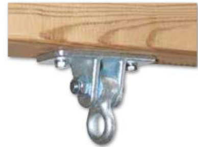
25 Schaukelhaken verzinkt, für Schaukeln, mit Messinglager und Sicherheitsmutter zur Aufhängung an der Unterseite der Querstange. Schraubenlöcher Ø 13 mm, Öse für die Befestigung von Seilen oder Ketten mit Ø 20 mm. Gesamtmaß 130 x 50 x 100 mm.
